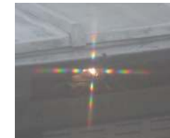
Irisations dues à la superposition des figures de diffraction en lumière blanche
